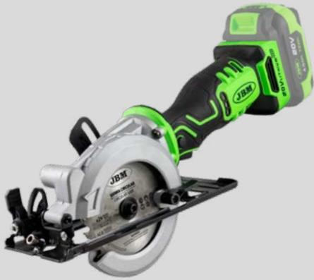
Mini sega circolare con motore brushless lato posteriore ref. 60011 è progettato per segare il legno. La sega circolare di 115 mm di diametro con 24 denti è ideale per tagli diritti longitudinali e trasversali e per segare con un angolo fino a 45° su tavole e pannelli di legno.
