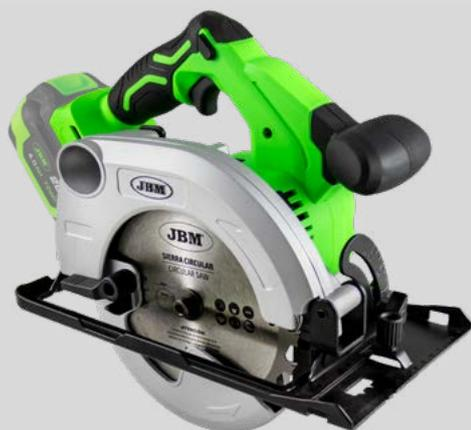
Questo sega circolare con motore brushless ref. 60007 è progettato per segare il legno. La sega circolare di 165 mm di diametro con 24 denti è ideale per tagli diritti longitudinali e trasversali e per segare con un angolo fino a 45° su tavole e pannelli di legno.
