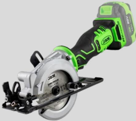
Serra circular com a localização traseira do motor sem escovas ref. 60011 foi projetada para serrar madeira. A serra circular com um diâmetro de 115 mm com 24 dentes é ideal para cortes longitudinais/transversais diretos e para serrar até 45° de tábuas e painéis de madeira.
