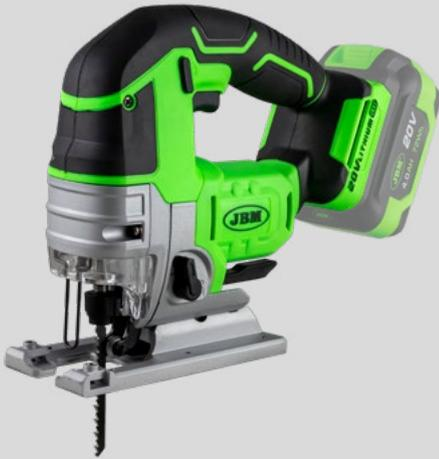
Dieses Laubsäge mit bürstenlosem motor ref. 60010 ist fürs Sägen von Materialien wie Holz, Stahl, Kunststoff und Metall vorgesehen. Die Laubsäge ist mit einem 4-Positionen-Pendelmechanismus ausgestattet: 3 Positionen fürs Orbitalschneiden und 1 Position fürs direkte Schneiden, so dass Sie eine optimale Schnittgeschwindigkeit abhängig von der Härte des Materials wählen können.
